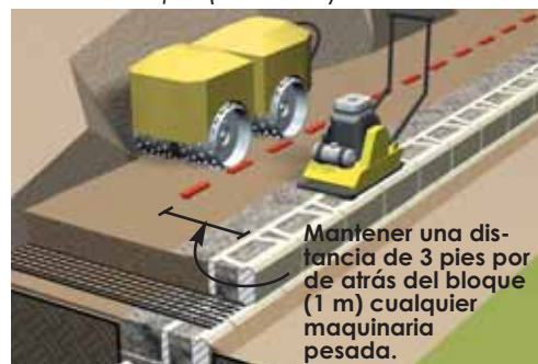
Mantener una distancia de 3 pies por de atrás del bloque (1 m) cualquier maquinaria pesada.
