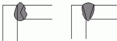
Figura 5.2.1.C.- Soldaduras a tope en L
